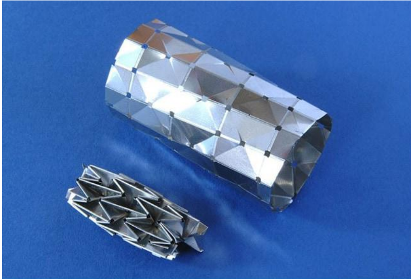
Figure 5. Modèle d'un stent d'origami coronaire dans sa forme pliée et déployée, développé par Zhong You et Kaori Kuribayashi-Shigetomi. 18
